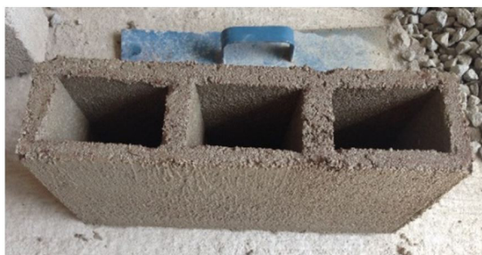
Figura 1. Bloco imediatamente após a desforma
